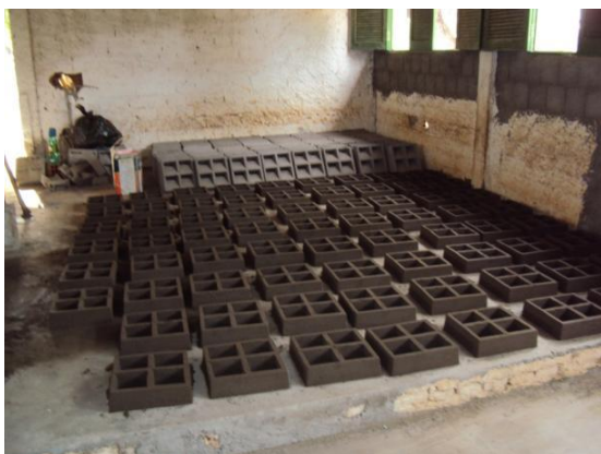
Figura 126 – Produção de elementos vazados em concreto pré-moldado em 26 jul. 2010
